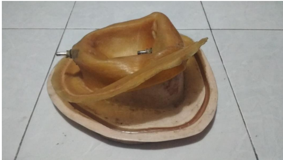
Gambar 3. 16 Pemasangan Lateks Pada Cetakan
