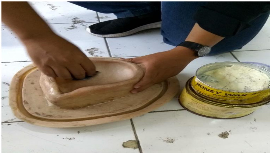
Gambar 3. 13 Pengolesan Wax Pada Cetakan
