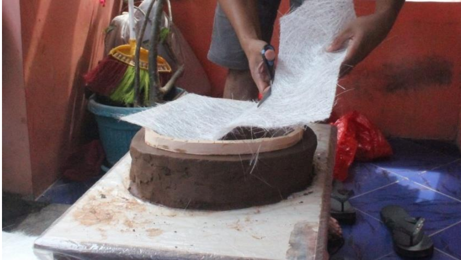
Gambar 3. 5 Pemotongan Serat Kaca Acak
