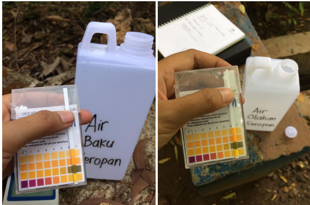
Gambar 4.14 Hasil Pengujian pH pada Air Baku dan Air Olahan SPAM Seropan (sumber : dokumentasi pribadi)
