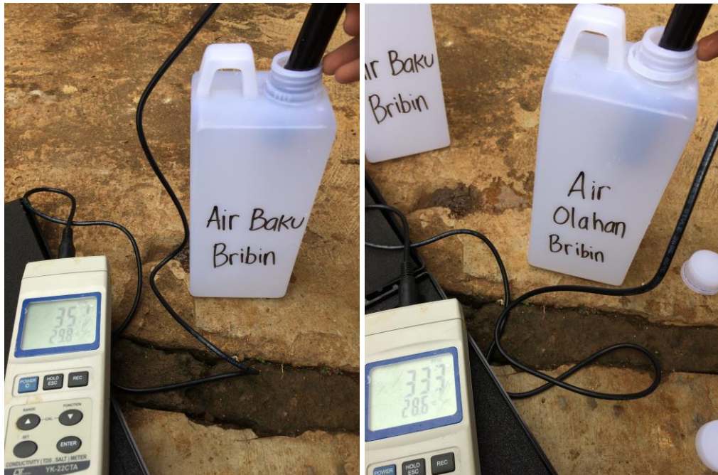
Gambar 4.9 Hasil Pengujian TDS dan Suhu pada Air Baku dan Air Olahan SPAM Bribin (sumber : dokumentasi pribadi)
