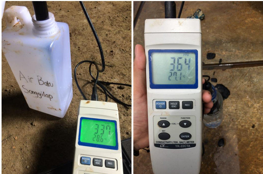
Gambar 4.17 Hasil Pengujian TDS dan Suhu pada Air Baku dan Air Olahan SPAM Songgilap (sumber : dokumentasi pribadi)
