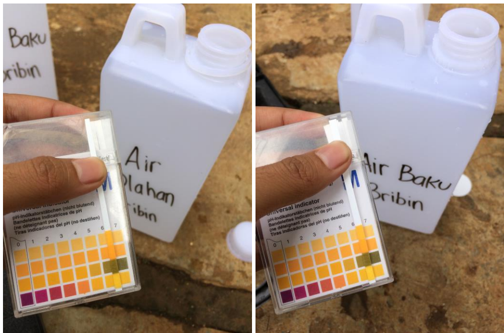
Gambar 4.10 Hasil Pengujian pH pada Air Baku dan Air Olahan SPAM Bribin (sumber : dokumentasi pribadi)
