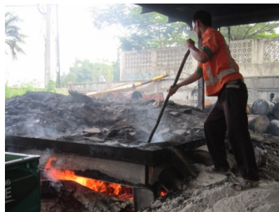
Gambar 4.41. Pengadukan yang Telah Ditambahkan Pasir
