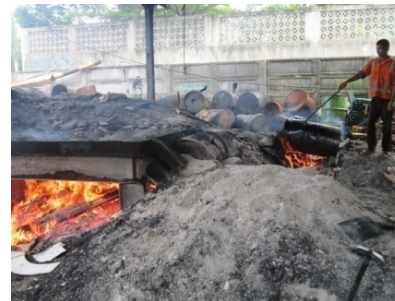
Gambar 4.42. Pembakaran Abu Aspal
