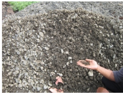
Gambar 4.38a Aspal yang Sudah Tidak Bisa Digunakan
