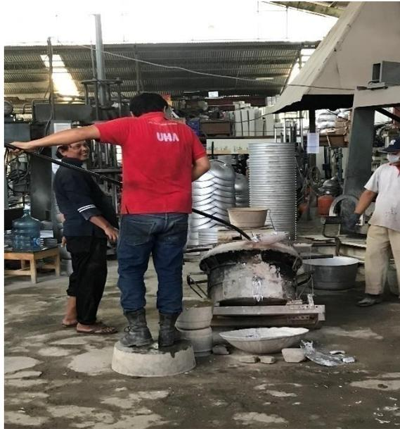
Gambar 4. 4 Penuangan Logam Cair
