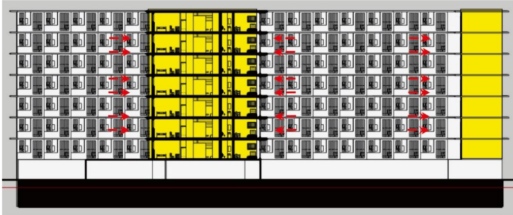
GAMBAR : 51 skematik void pada bangunan dan arah angin masuk kedalam ruang Sumber : Analisis Penulis , 2018
