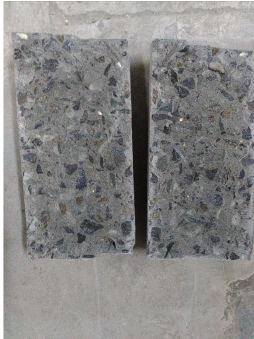
Gambar L-6.1 Hasil Pengujian Kuat Tarik Belah Beton BN
