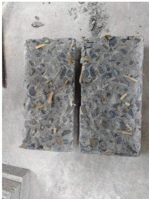
Gambar L-6.4 Hasil Pengujian Kuat Tarik Belah Beton BSR 1,5
