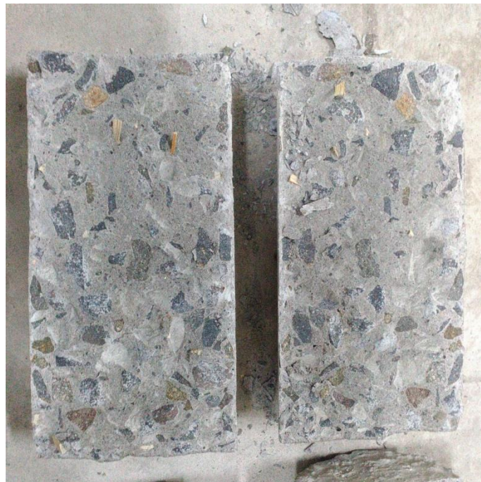
Gambar L-6.2 Hasil Pengujian Kuat Tarik Belah Beton BSR 0,5
