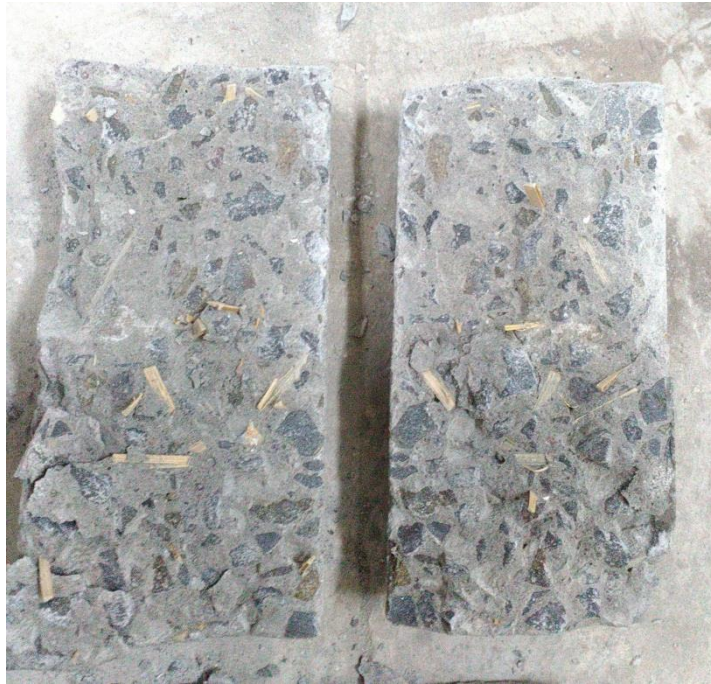
Gambar L-6.3 Hasil Pengujian Kuat Tarik Belah Beton BSR 1
