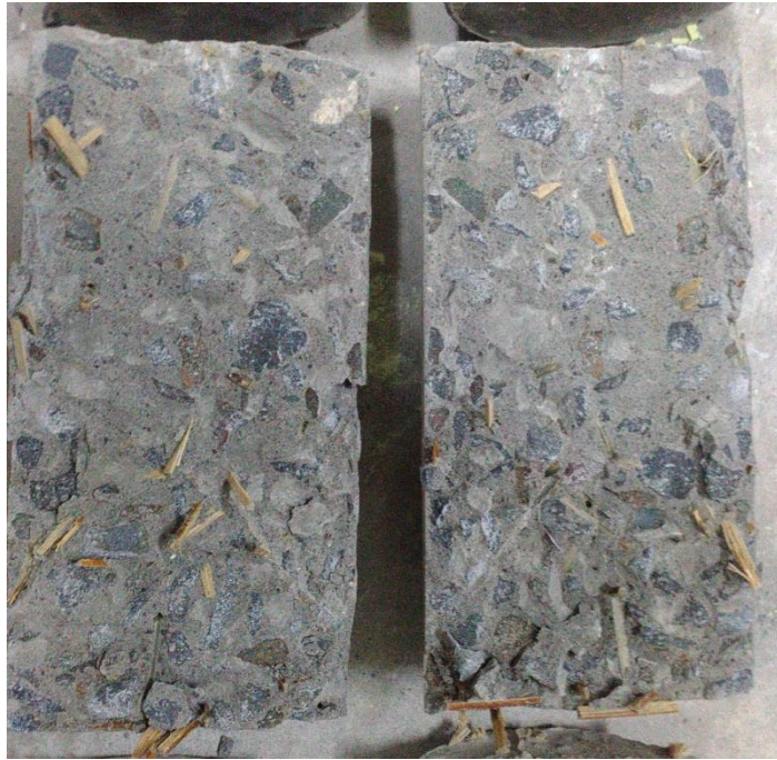
Gambar L-6.5 Hasil Pengujian Kuat Tarik Belah Beton BSR 2
