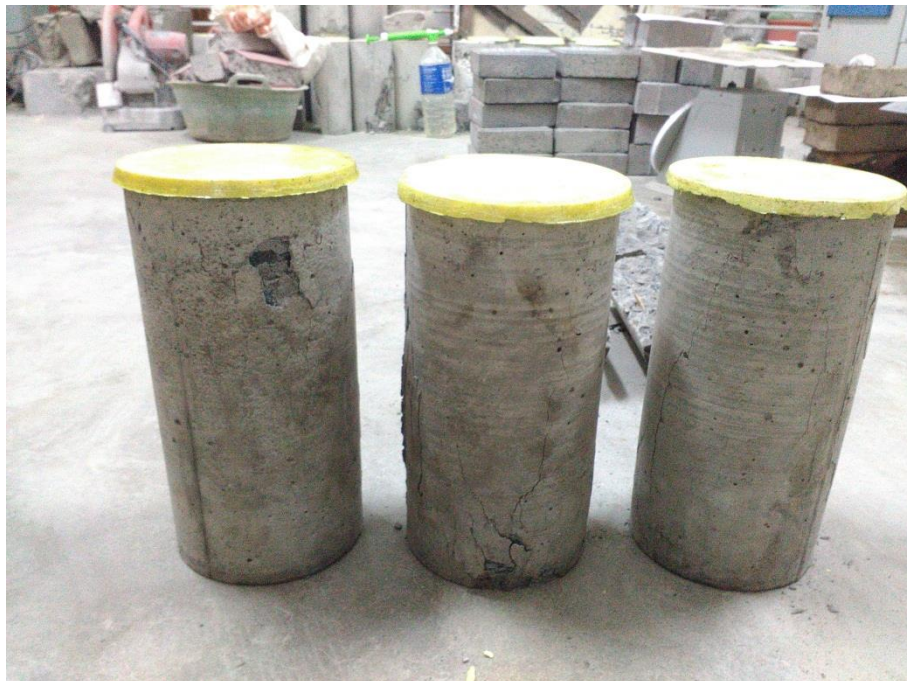
Gambar L-5.2 Hasil Pengujian Kuat Tekan Beton BSR 0,5
