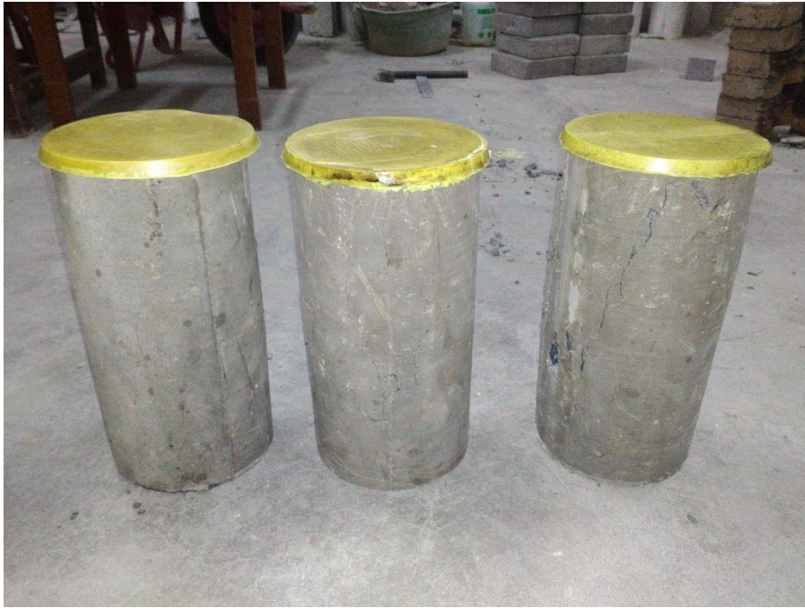
Gambar L-5.5 Hasil Pengujian Kuat Tekan Beton BSR 2
