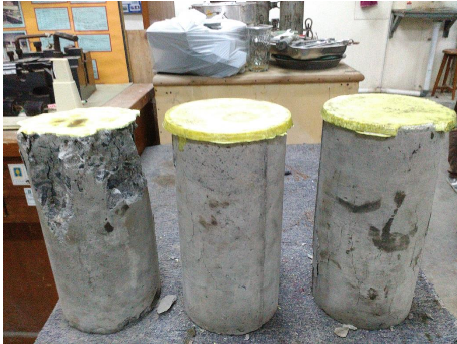
Gambar L-5.1 Hasil Pengujian Kuat Tekan Beton BN
