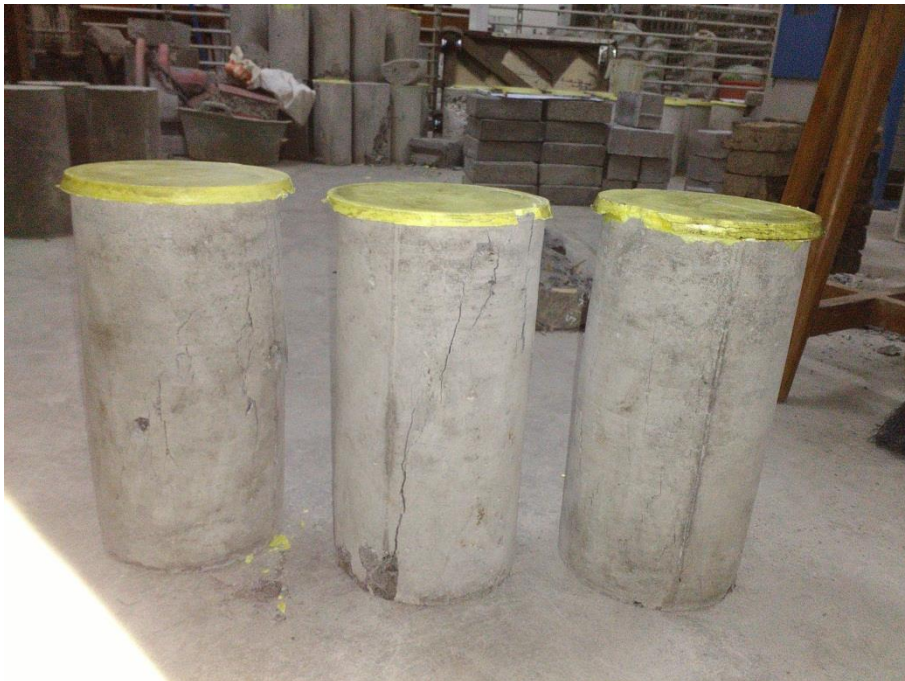
Gambar L-5.4 Hasil Pengujian Kuat Tekan Beton BSR 1,5
