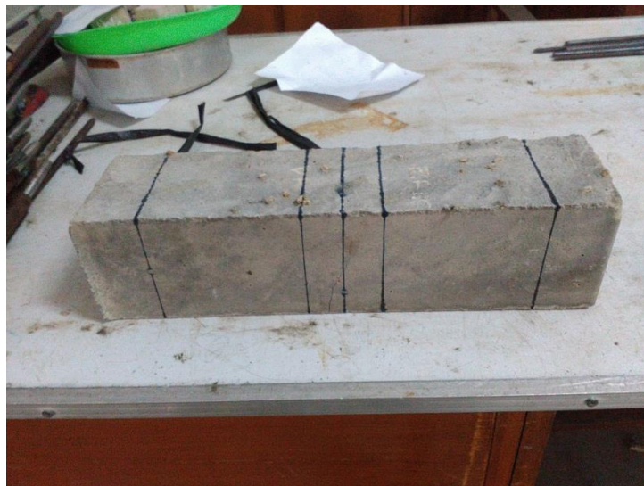
Gambar 5.26 Benda Uji Lentur Balok BSR 2
