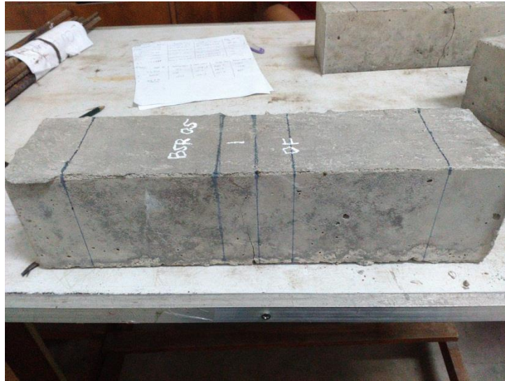
Gambar 5.23 Benda Uji Lentur Balok BSR 0,5
