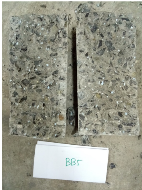
Gambar L-3.3 Hasil Pengujian Kuat Tarik Beton
