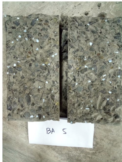
Gambar L-3.3 Hasil Pengujian Kuat Tarik Beton
