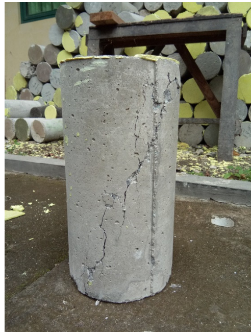
Gambar L-3.2 Hasil Pengujian Kuat Tekan dan Modulus Elastisitas Beton
