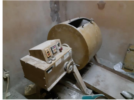
Mesin Loss Angeles
