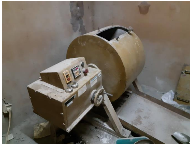
Mesin Loss Angeles
