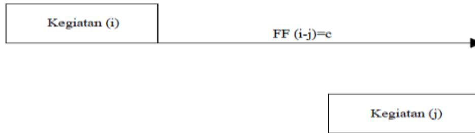
**Gambar 3.6 Denah FF Pada Node PDM**
