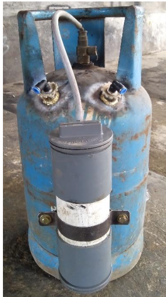
Gambar 4. 1 Hasil perancangan tabung vakum
