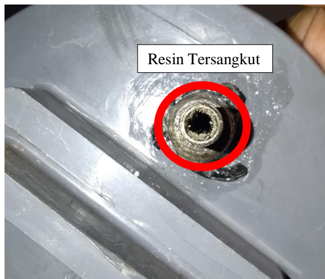
Gambar 4. 10 Resin Pada lubang Inlet Tabung filter
