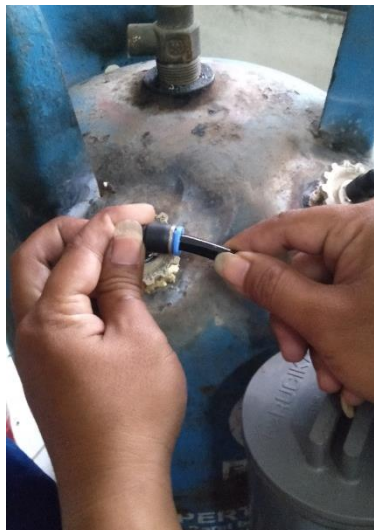
Gambar 4.6 Pemasangan selang pada tabung reservoir
