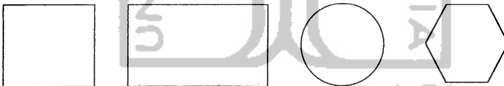
Gambar 3.2. Bentuk Denah Bangunan yang Sederhana dan Simetris (Tular, 1981)
