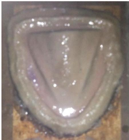
Gambar 4.6 Master cetakan *windshield* sudah dituang campuran resin
