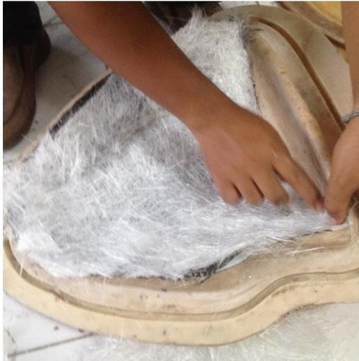
Gambar 3.6 Proses penyusunan komposit
