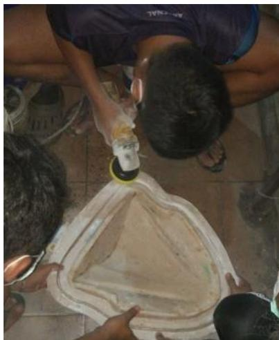
Gambar 4.8 Proses *finishing* cetakan
