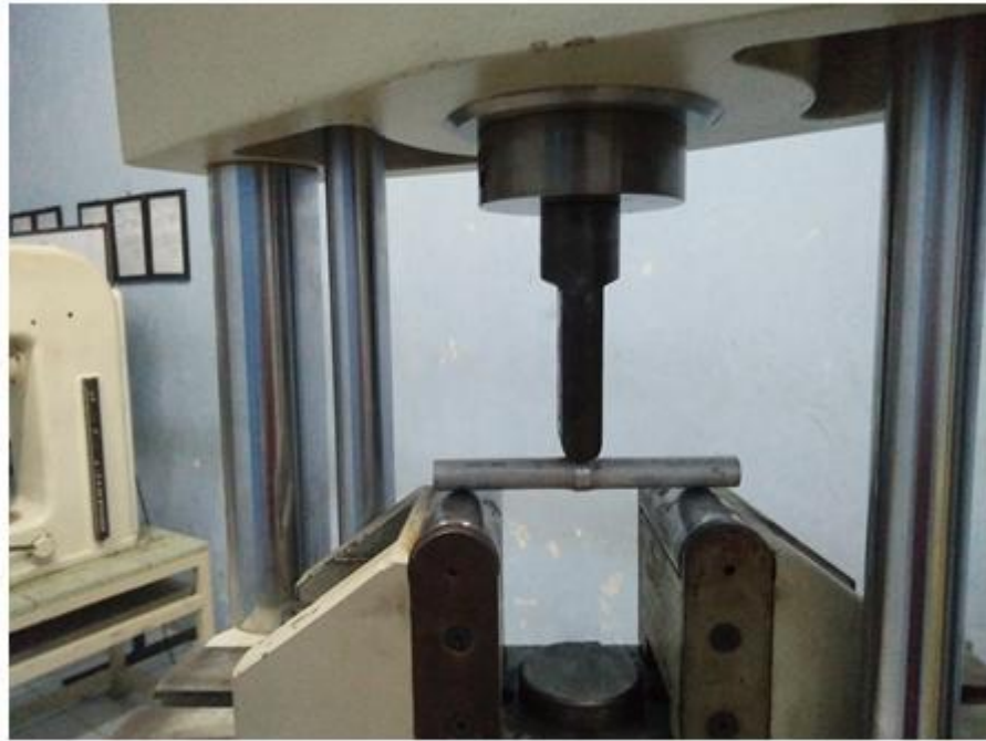
Gambar 3.49 Memasang bahan pengujian bending
