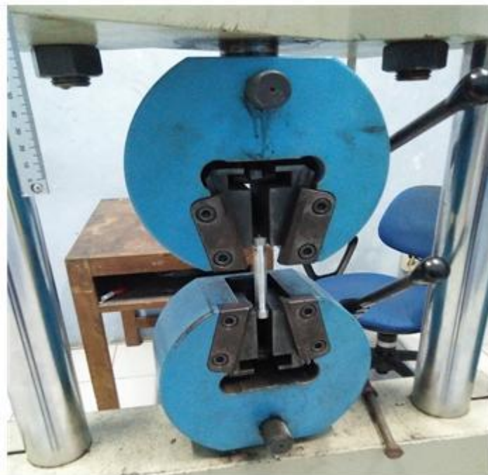
Gambar 3.46 Peletakkan bahan uji tarik
