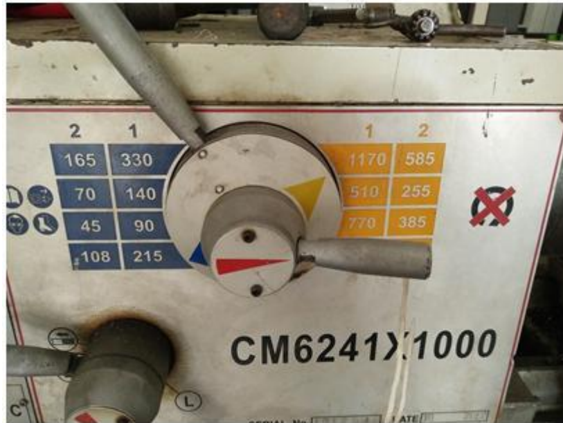
Gambar 3.29 Kecepatan putar spindle 1170 RPM
