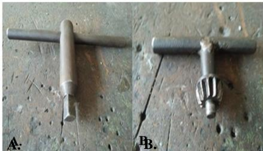
Gambar 3.27 A. Kunci spindle, B. Kunci chuck bor
