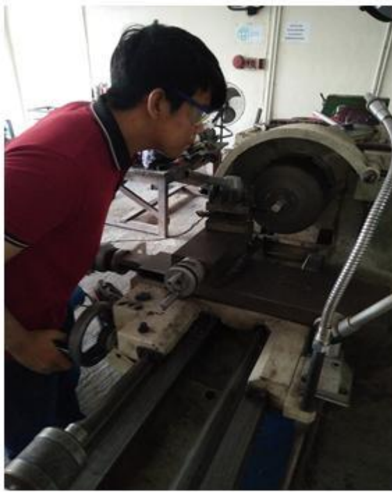
Gambar 3.21 Perataan permukaan dengan mesin bubut.
