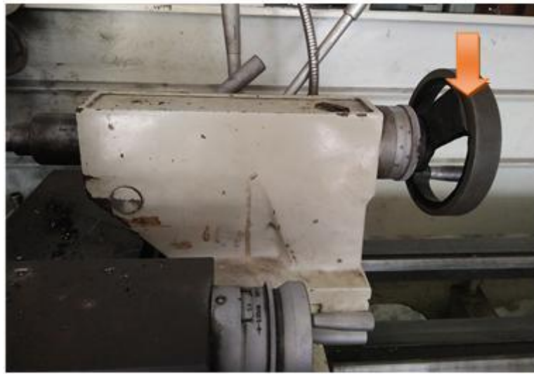
Gambar 3.30 Tuas putar pada tail stock agar bahan statis bergerak maju
