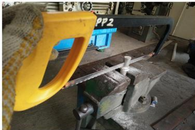
Gambar 3.38 Pemotongan bahan uji
