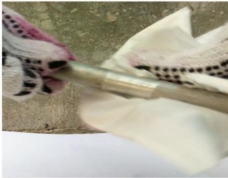
Gambar 3.34 Pembersihan cairan penetrant setelah 10 menit
