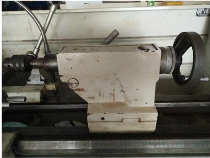
Gambar 3.26 Chuck bor yang di pasang pada tail stock
