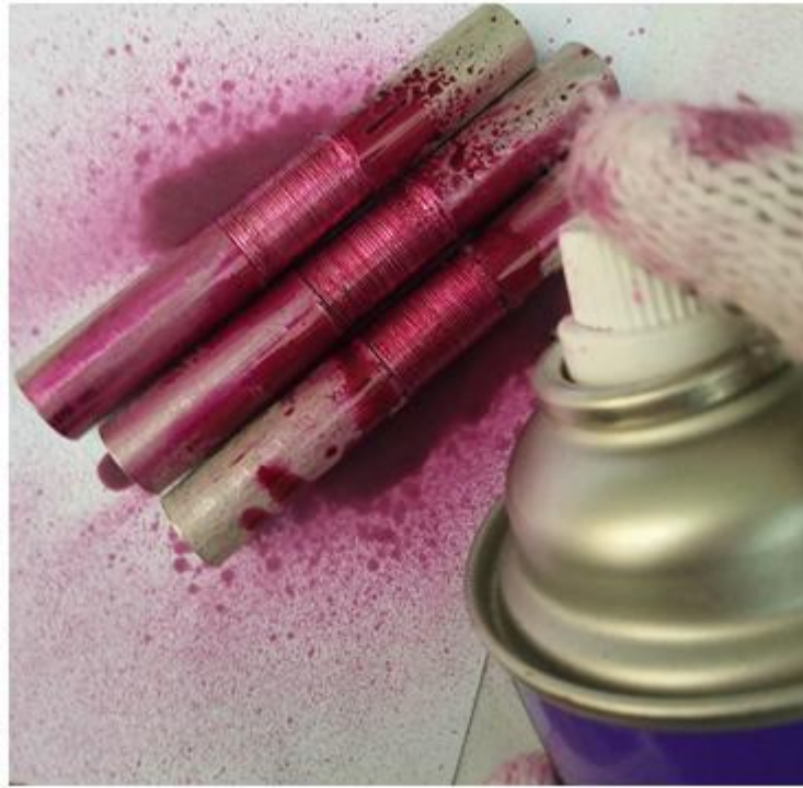
Gambar 3.33 Pemberian cairan penetrant
