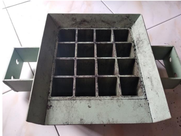
Gambar 4-2 Gambar Perancangan Cetakan dan Corong
