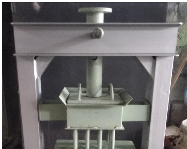
Gambar 4-17 Gambar Lubang Atas Sebagai Pengunci
