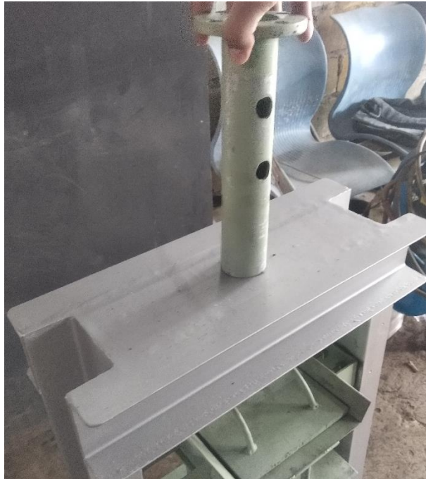
Gambar 4-16 Gambar Memasukkan Penahan ke Rangka
