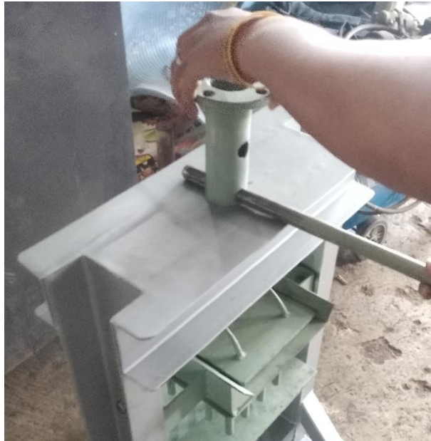
Gambar 4-18 Gambar Memasang Pengunci Lubang Bawah
