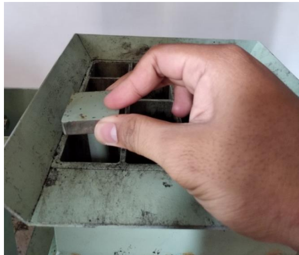
Gambar 4-15 Gambar Memasukkan Penekan ke Cetakan
