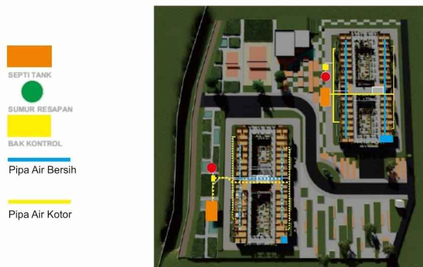
Gambar 5. 40 Distribusi air bersih dan air Kotor
