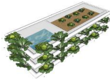
Gambar 5. 24 Rancangan baru sistem Hidroponik dan aquaponik pada balkon setiap hunian dengan sistem model 2
