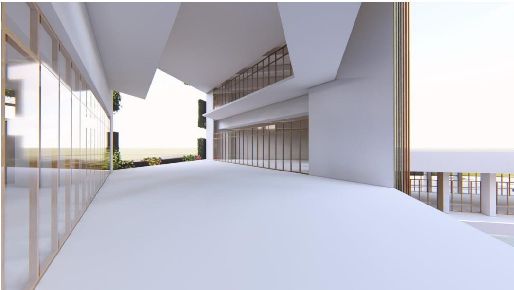
Gambar 4.6 Lubang pada Massa Bangunan Untuk Jalur Angin
