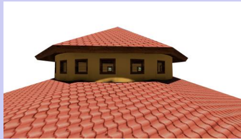
Gambar 4.12 Ventilasi di atap sebagai penerapan stack effect pada bangunan musholla .
