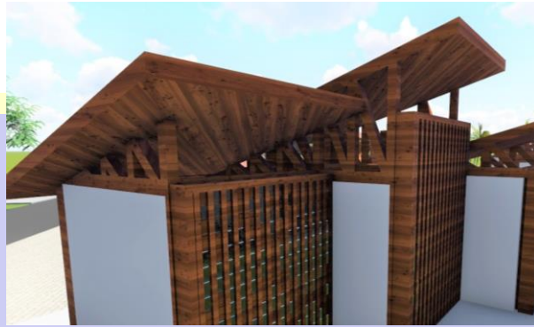
Gambar 4.7 Lubang udara pada bangunan kios entrance
