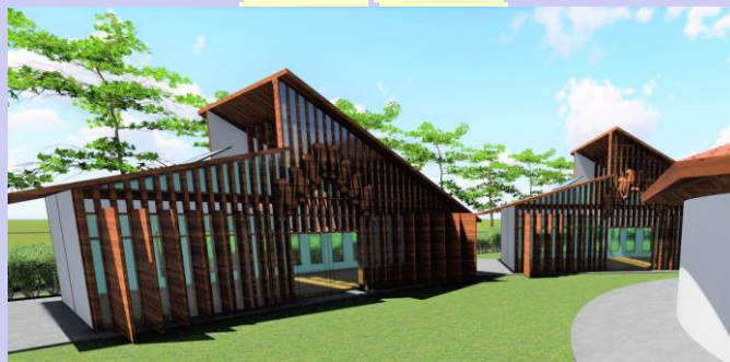
Gambar 4.18 Bukaan di bagian atap ruang istirahat untuk jalan masuk angin Sumber Hasil rancangan Ramadhani, 2018.
