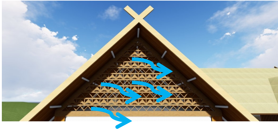
Gambar 4.14 secondary skin pada atap bangunan
