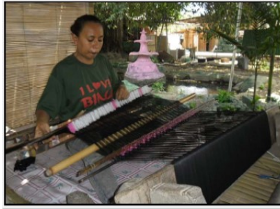
Gambar 2.32 memasukan benang kecau atau sisir tenun
