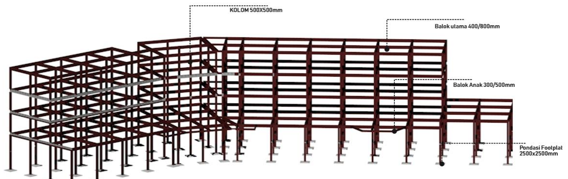
Gambar 4.35 Aksonometri Struktur Bangunan 1
