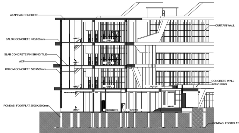
Gambar 4.18 Potongan B-B' Bangunan A
