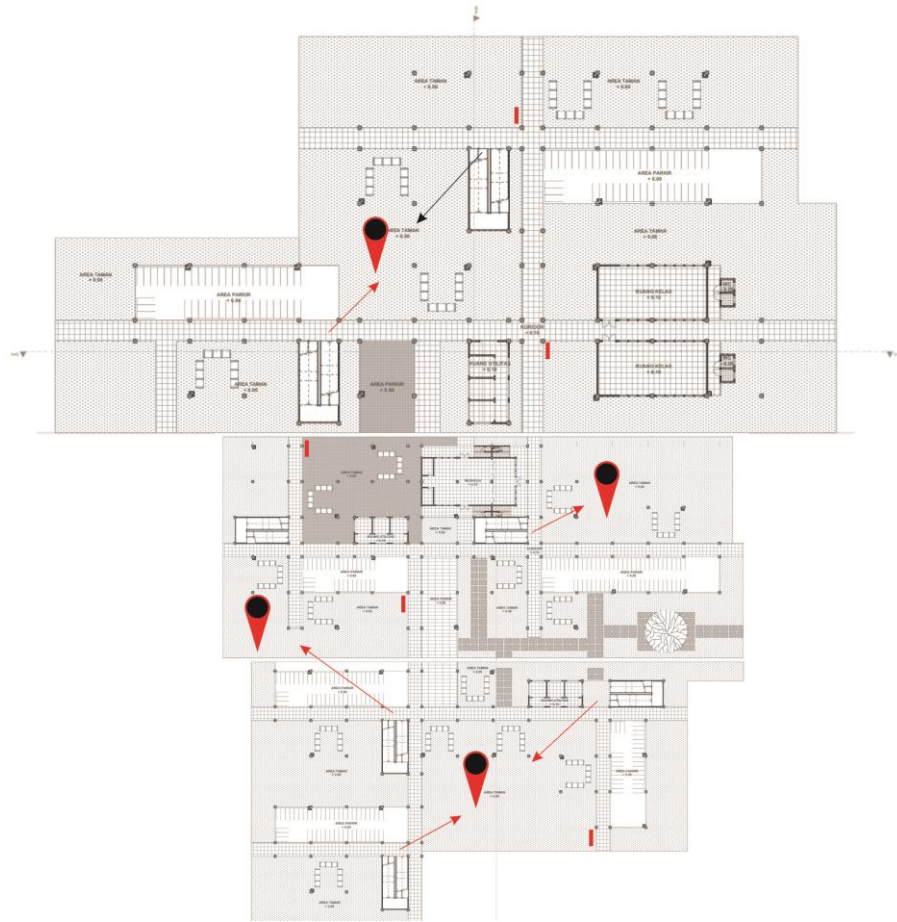
Gambar 5 - 28 Skema Keselamatan Bangunan
