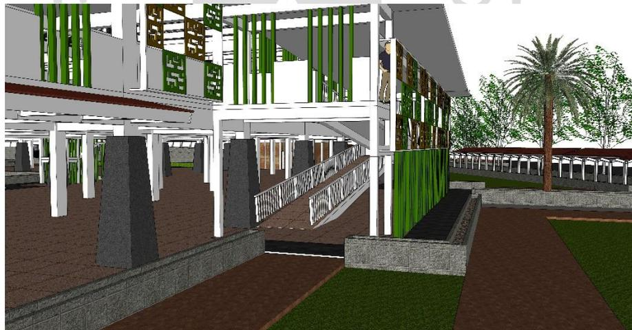
**Gambar 4.7** Skematik Sistem Akses Difabel Menggunakan Ramp
