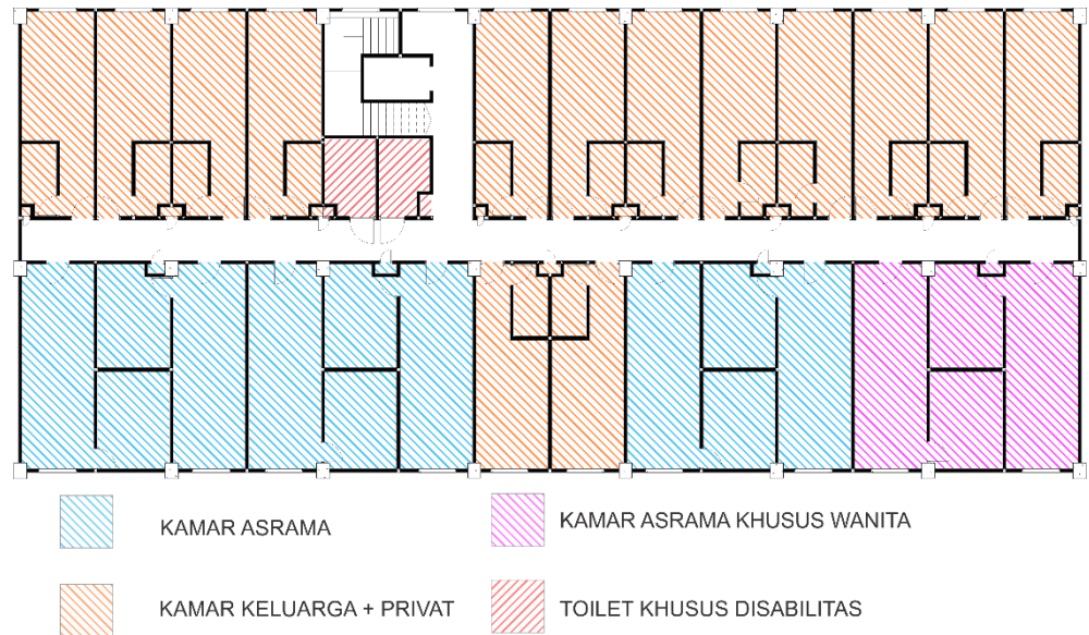
Gambar 3.5 Skema Pembagian Ruang Pada Lantai 3
