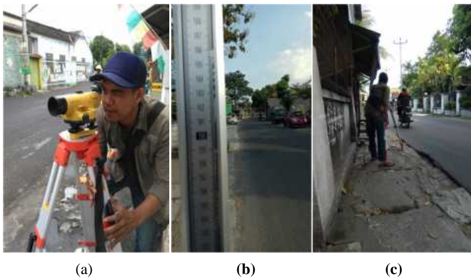
Gambar 5.4 Dokumentasi Pengukuran Kemiringan Saluran Drainase
