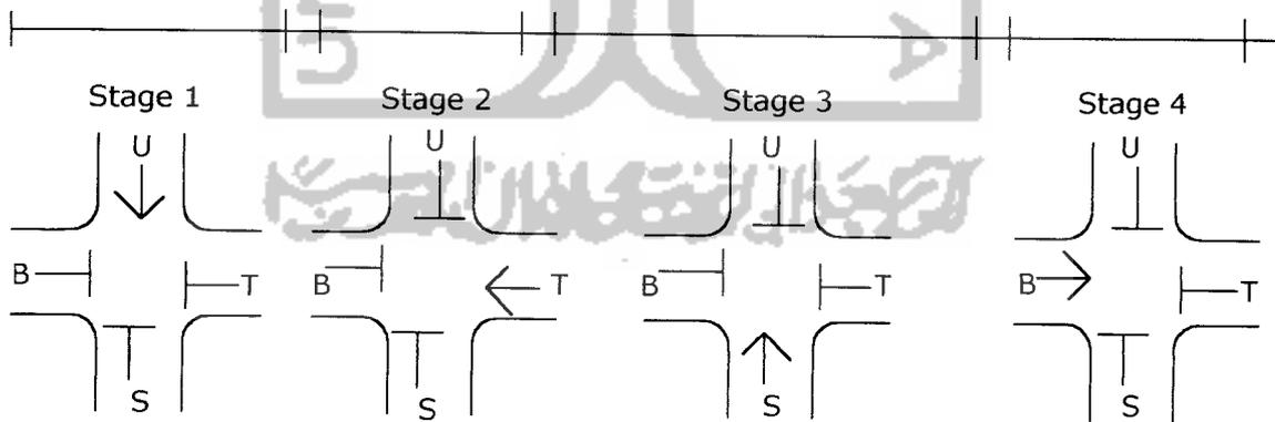
Gambar 5.1 Diagram pengaturan Phase dan Stage Simpang Pingit
