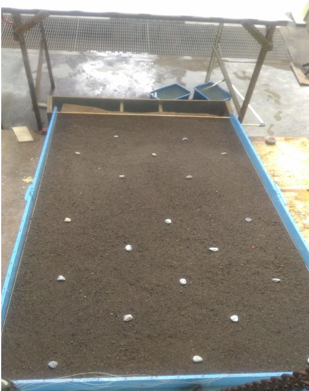
Gambar 5. 7 Kondisi Sedimen Pada Kemiringan 15^\circ Setelah Running pada Kemiringan 15^\circ
