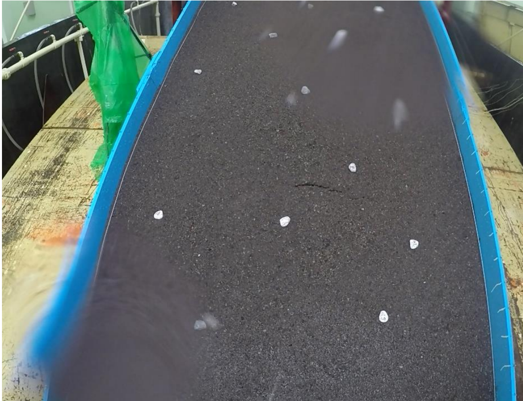
Gambar 5. 11 Kondisi Sedimen Pada Kemiringan 20° Setelah Running pada Kemiringan 20°
