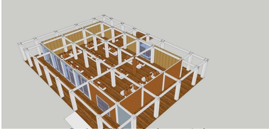
Gambar 3.7 Sistem Struktur terminal (Sumber: Penulis, 2017)
