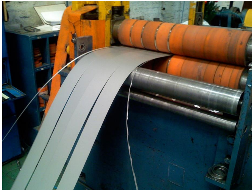
Gambar 2.0.37 Proses pembuatan Anyaman dari Aluminium (Sumber: Archdaily-XVI Chilean Architecture Biennale,2018)
