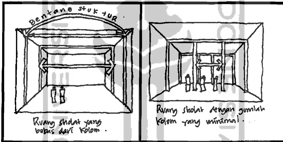
Gambar 48 : Konsep Perancangan Struktur Bangunan
