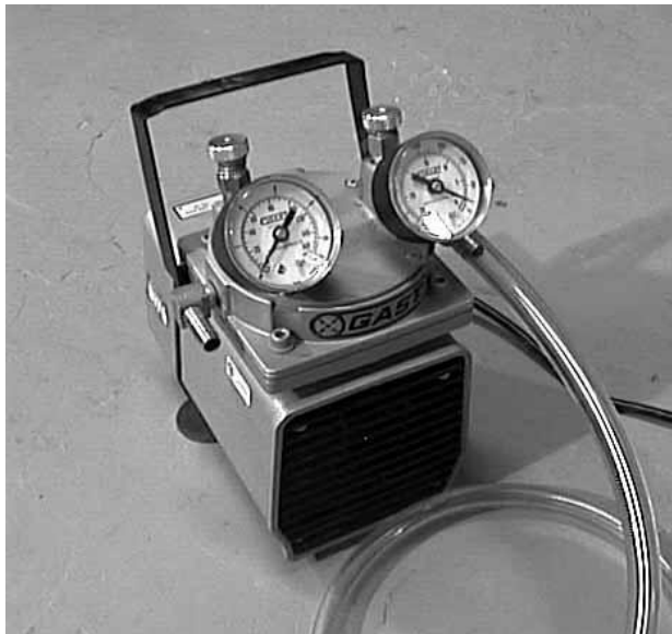
Gambar 2.4 Contoh Pompa untuk Ukuran Cetakan Kecil ( Vacuum Bagging Technique, 2010)
