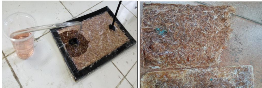
Gambar 4.7 Proses Pembuatan Layer Serat Bulu Ayam dengan Menggunakan Metode Vacuum Bagging Pempvakuman Satu Konektor
