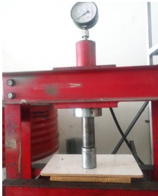
Gambar 4.4 Pengepresan Komposit Sandwich
