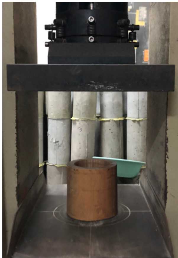
Gambar L-25.2 Pengujian Kuat Tekan Bambu
