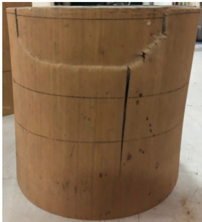
Gambar L-25.3 Hasil Pengujian Kuat Tekan Bambu
