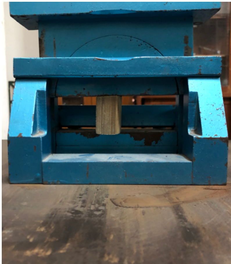
Gambar L-24.2 Pengujian Kuat Geser Bambu
