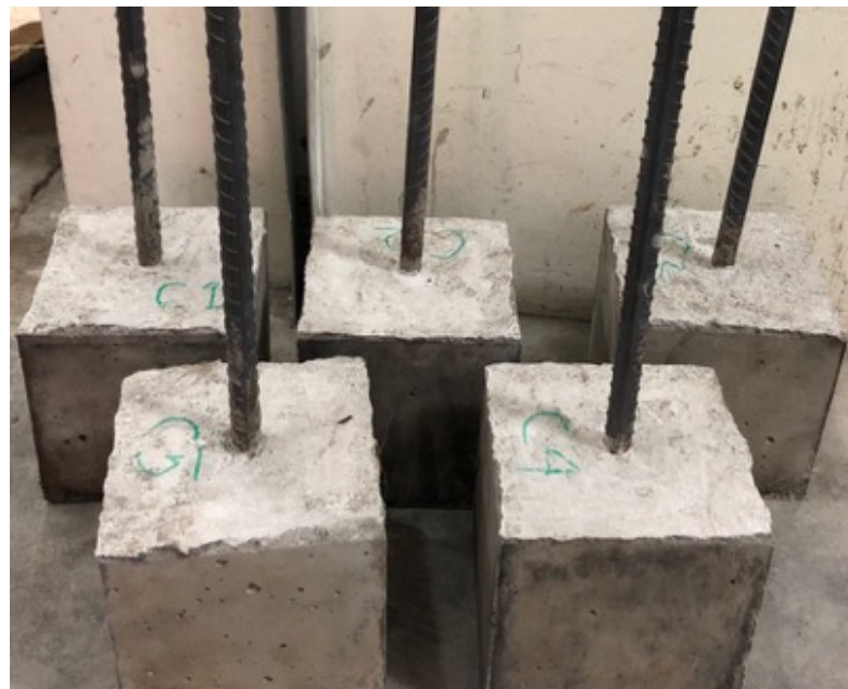
Gambar L-23.2 Benda Uji Kuat Cabut Tulangan Baja
