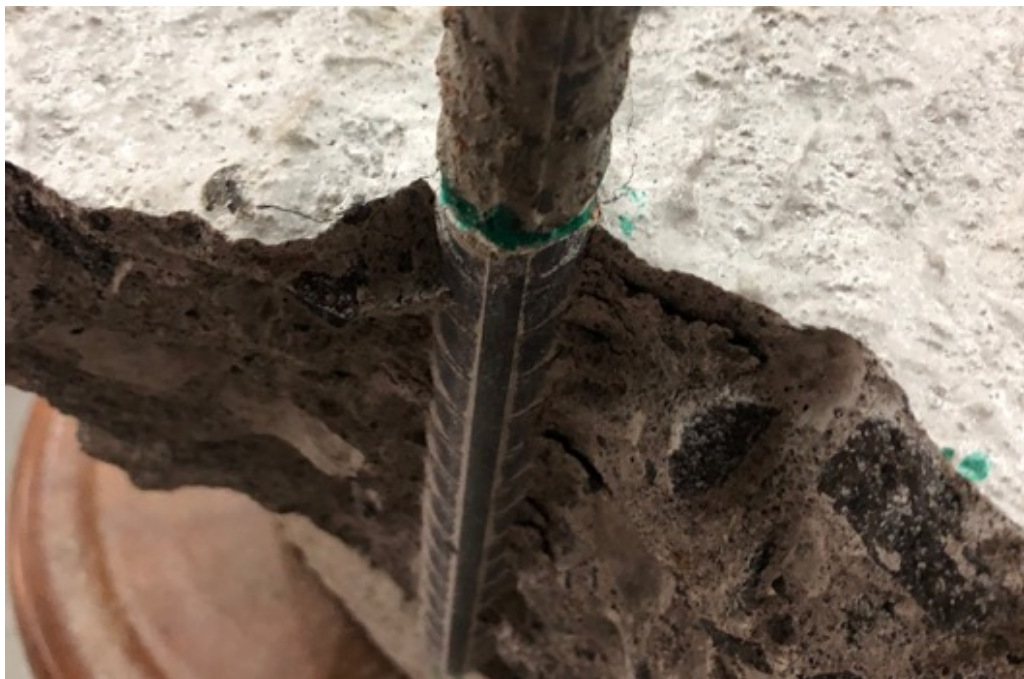
Gambar L-22.4 Hasil Pengujian Kuat Cabut Tulangan
