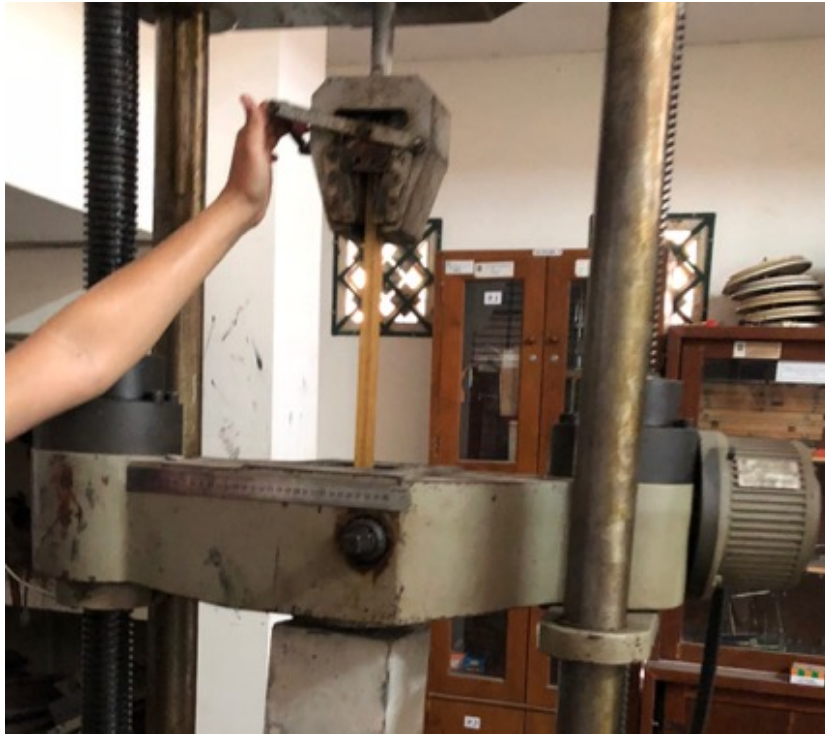
Gambar L-23.3 Pengujian Kuat Cabut Tulangan
