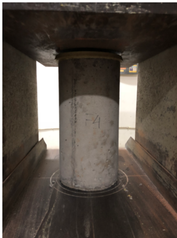
Gambar L-22.4 Pengujian Kuat Desak Beton
