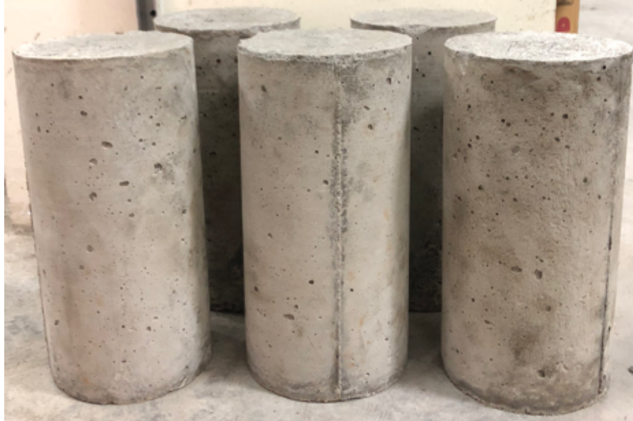
Gambar L-22.1 Benda Uji Kuat Desak Beton
