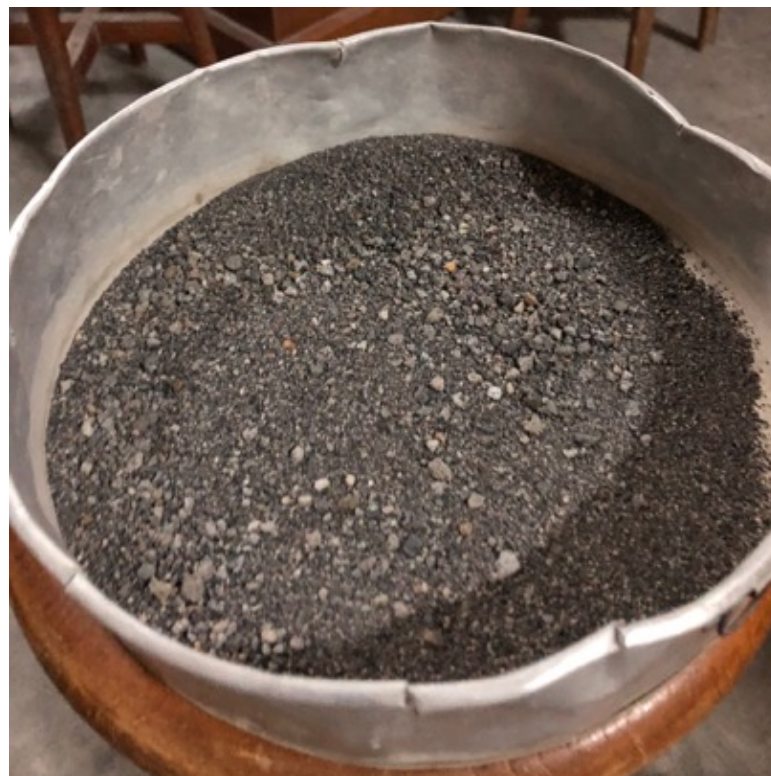
Gambar L-20.5 Agregat Halus Kering tanpa Lumpur
