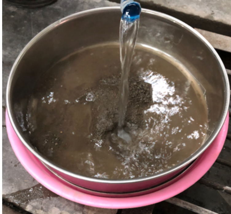
Gambar L-20.2 Penyaringan Lumpur Agregat Halus
