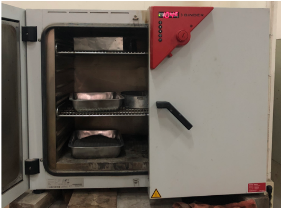
Gambar L-20.4 Pengeringan Agregat Halus Menggunakan Oven
