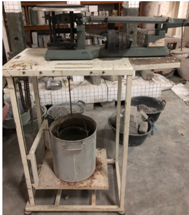
Gambar L-17.2 Penimbangan Agregat Kasar di dalam Air
