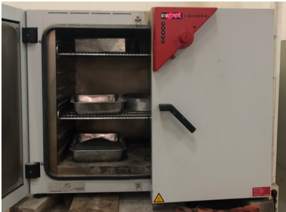
Gambar L-17.3 Pengeringan Agregat Kasar Menggunakan Oven
