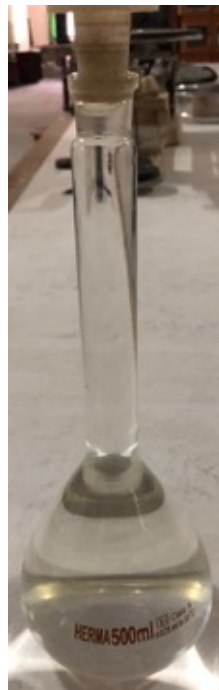
Gambar L-16.2 Piknometer Berisi Air
