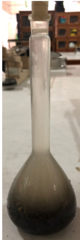
Gambar L-16.3 Piknometer Berisi Air dan Agregat Halus
