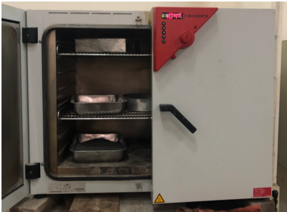
Gambar L-16.4 Pengeringan Agregat Halus Menggunakan Oven
