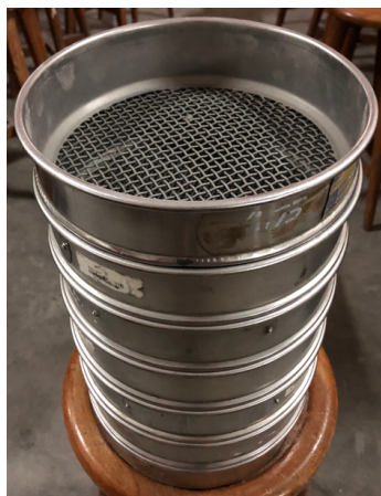
Gambar 4.9 Set Ayakan Agregat Halus (kiri) dan Kasar (kanan)
