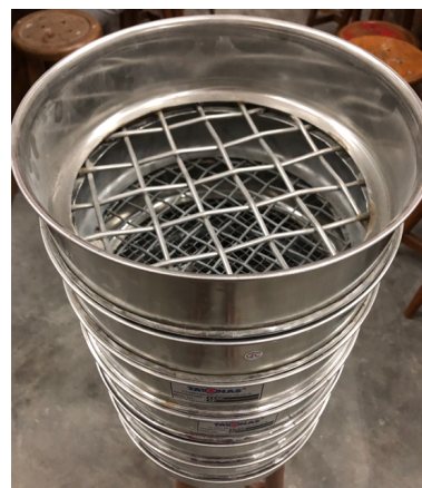
Gambar 4.9 Set Ayakan Agregat Halus (kiri) dan Kasar (kanan)
