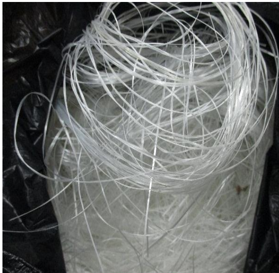
Gambar 2.6 Serat E-Glass dalam bentuk benang tipis
