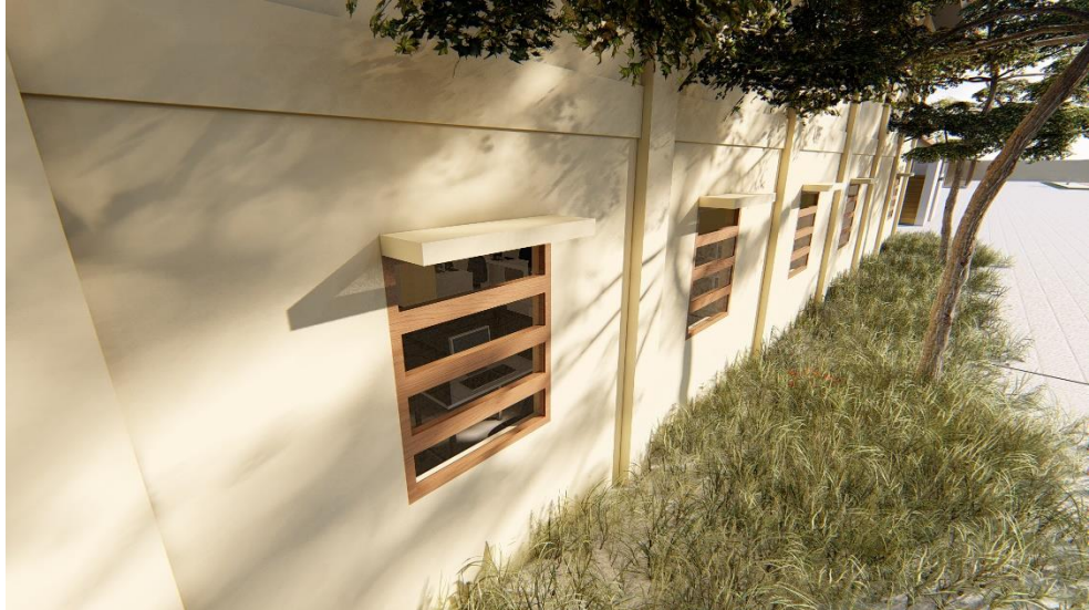
Gambar 6.2: Penambahan shading dan ukuran jendela diperkecil.
