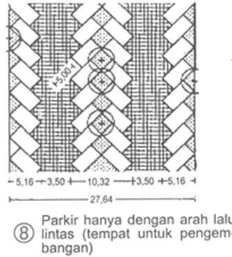
Gambar 2-19 peletakan parkir diagonal pada dua sisi (sumber: Neufert, 2002)
