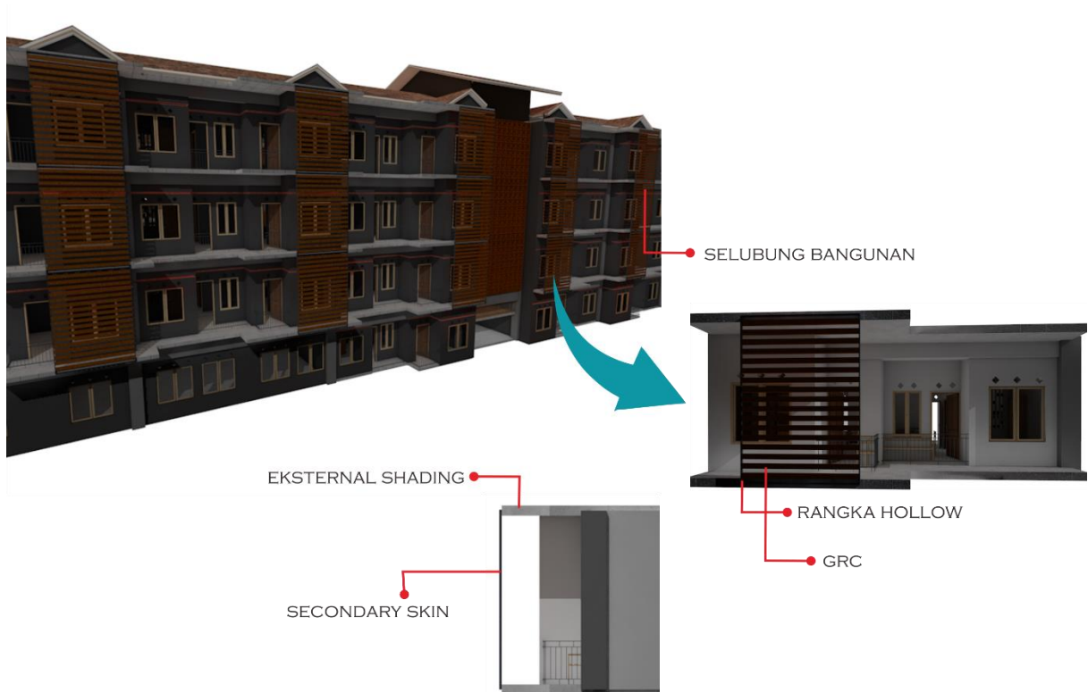
Gambar 3. 4 Skema Selubung bangunan
