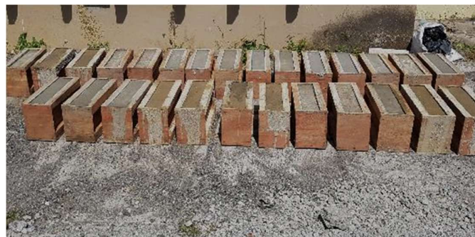
Benda Uji Setelah dicetak
