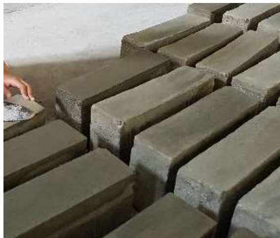
Batako Setelah di Capping dengan Pasta Semen
