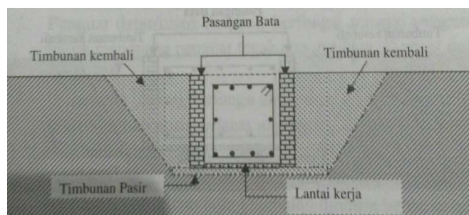
Gambar 3.3 Formwork Ground Beam dengan Pasangan Batu
