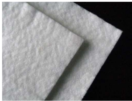
Gambar 3.5 Geotekstil Non Woven (Sumber: Indiamart, 2018)
