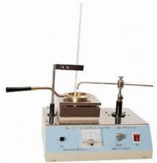
Gambar L-30.1 Alat pengujian titik nyala dan titik bakar aspal
