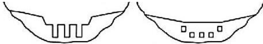
Gambar 3.4 Sabo Dam Tipe Terbuka Berbentuk Silt (Kiri) dan Lubang (Kanan)
