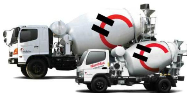
Gambar 4.7 Mini Mixer Truck dan Mixer Truck Standar
